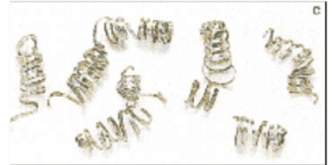
Свободно намотанная (витая) стружка – идеальные условия резания
