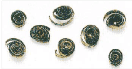
Толстая, тяжелая, с голубым отливом стружка – полотно перегружено
